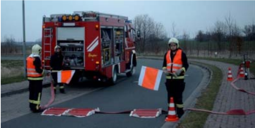
Abbildung 68: Absicherung einer Schlauchbrücke (Quelle: Verfasser)
