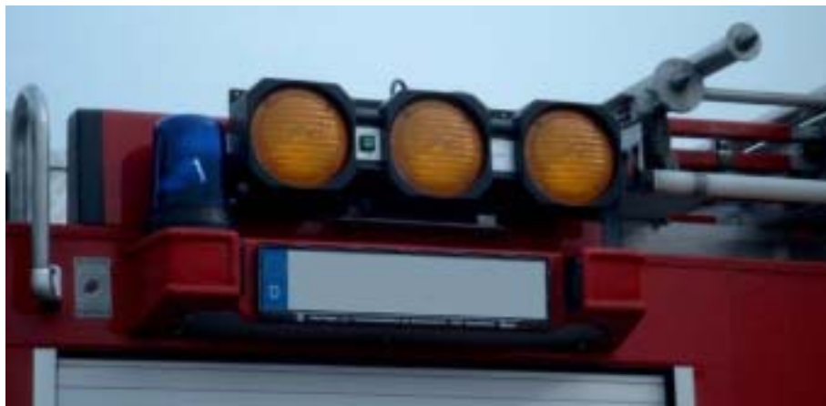
Abbildung 43: TRI-Blitz als Verkehrswarmanlage (Quelle: Verfasser)
