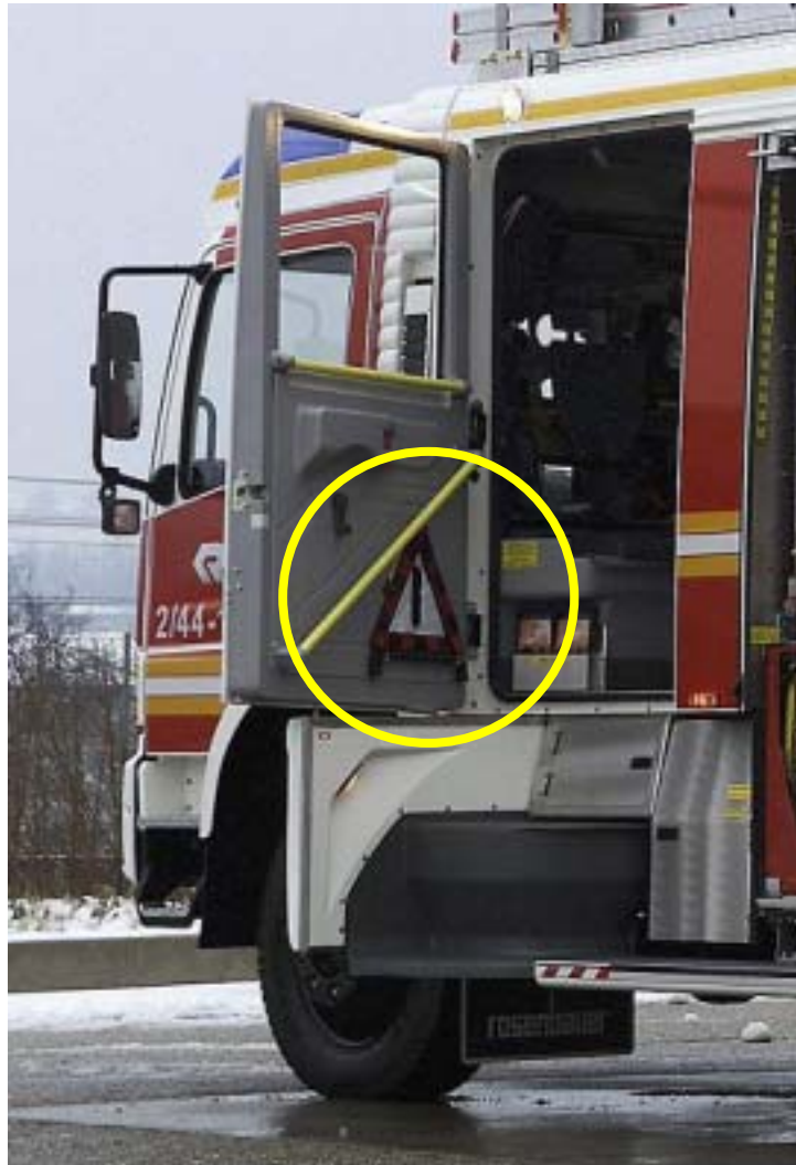
Abbildung 74: Warndreieck an der Tür eines Löschfahrzeuges gehalten (Quelle: Firma Rosenbauer, Leonding, Österreich)
