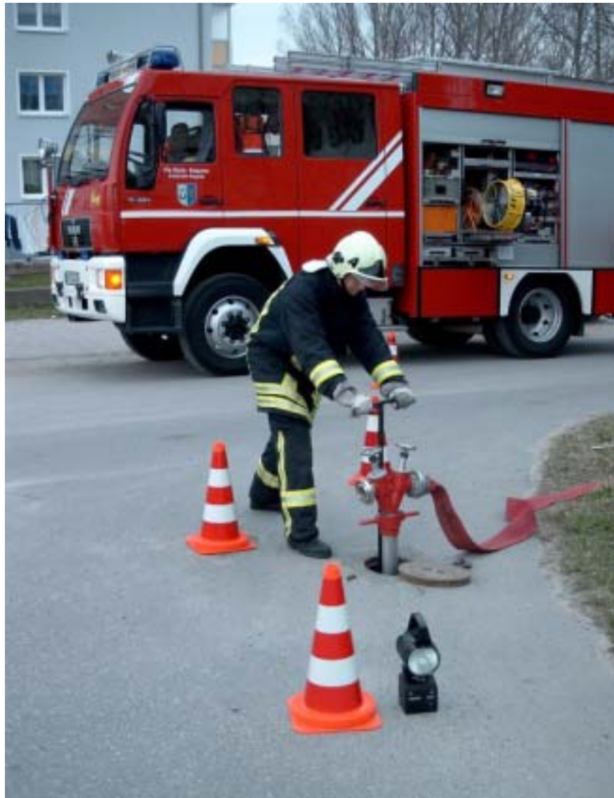
Abbildung 70: Kenntlichmachung eines Standrohres (Quelle: Verfasser)
