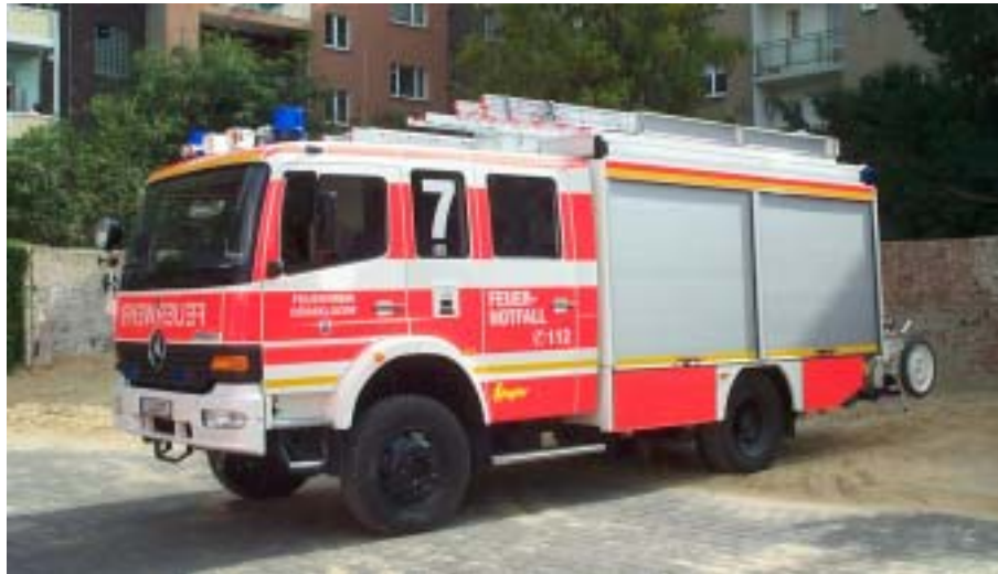
Abbildung 37: Löschfahrzeug mit leuchtroten Folien und Konturmarkierung
